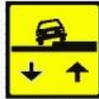
Denivelare față de banda alăturată
