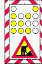
Semnalizarea unui utilaj care se deplasează lucrând
