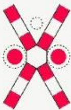
Trecere la nivel cu o cale ferată simplă, fără bariere, prevăzută cu semnale luminoase de avertizare a apropierei trenului
