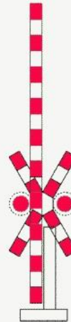
Trecere la nivel cu o cale ferată simplă cu semibarieră, prevăzută cu semnale luminoase de avertizare a apropierei trenului
