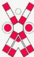
Trecere la nivel cu o cale ferată dublă, fără bariere, prevăzută cu semnale luminoase de avertizare a apropierei trenului
